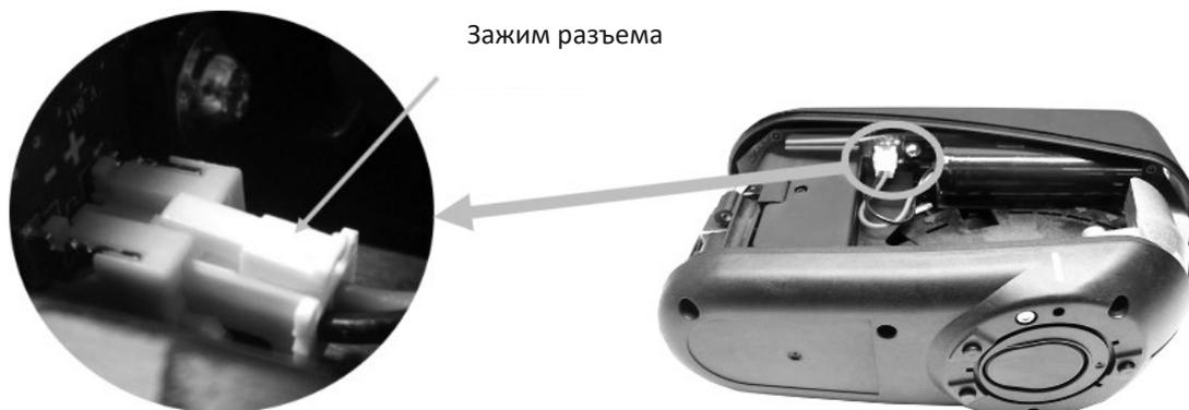
4. Вставьте новый аккумулятор в зажим и подключите разъем аккумулятора.
