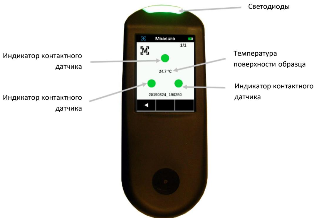
Многоцветный светодиод, расположенный на передней панели прибора, предоставляет визуальную обратную связь о состоянии измерения и контактного датчика.
